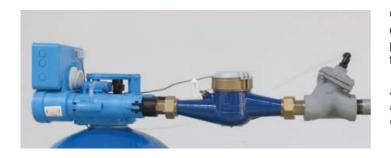
Gli addolcitori della serie AS/Meter sono completi di contatore ad impulsi e valvola a membrana, comandata idropneumaticamente, per interrompere l'erogazione di acqua, non trattata, durante la rigenerazione.
